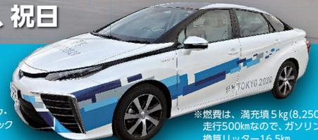
※燃料は、満充填5kg(8,250円)で走行500kmなので、ガソリン車換算リッター16.5km
